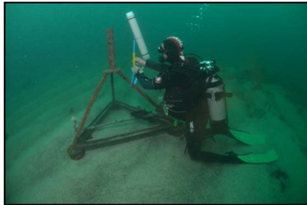
Photo 1: Placing of an AURAL hydrophone in Parc Naturel Marin d'Iroise Source: Parc Naturel Marin d'Iroise ©Yannis Turpin
