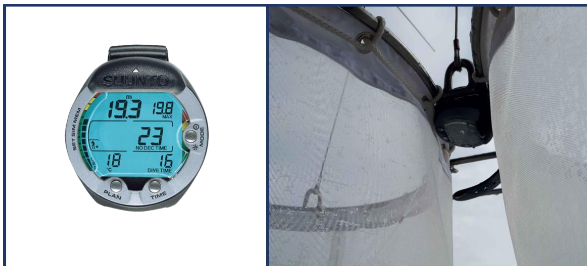
Figure 25: Détail de l'ordinateur de plongée utilisé et son positionnement sur le cadre du filet.
