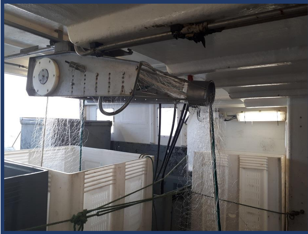
Figure 39: Filet trémail passant dans la pomailleuse, engin servant à le démêler.
