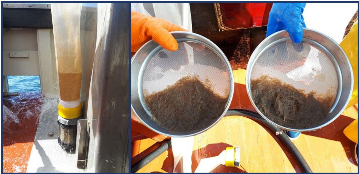
Figure 32: Colmatage partiel du filet – Refus de tamis importants.
