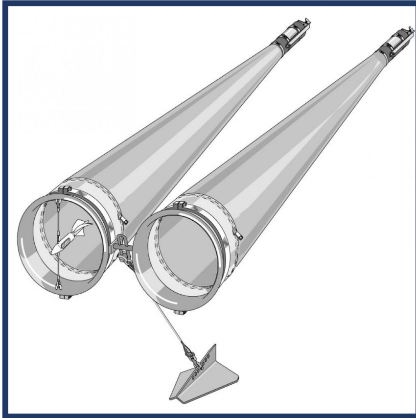
Figure 23: Vue schématique d'un filet Bongo en action, avec son dépresseur en aile et son volucompteur.
