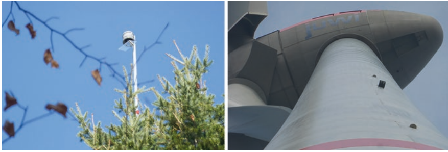
Abb. 2.2 Akustische Erfassungen an Waldstandorten vor (links) und nach (rechts) Errichtung der WEA. Vor Errichtung der WEA sollte die Fledermausaktivität idealerweise oberhalb der Baumkronen aufgezeichnet werden. Nach Errichtung der WEA wird zusätzlich zum Gondelmonitoring teils ein weiteres Erfassungsgerät am Mast im Bereich der unteren Rotorspitze installiert. (Links: © Robert Brinkmann, rechts: © Horst Schauer-Weissahn)
